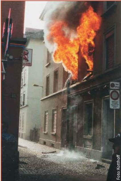
Abb. 2a: Brandüberschlag durch Fenster (Schadensfeuer)
