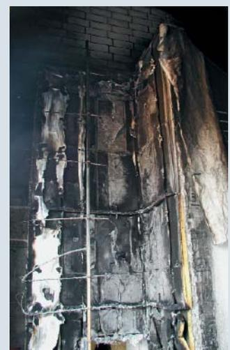
Die Bekleidung war zu Versuchsende vollständig verbrannt.
